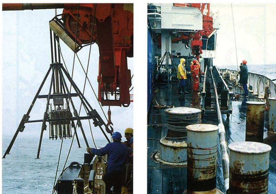
Abb. 3. Gerät zur Entnahme von Oberflächensedimentproben (Multicorer) nach Beprobung des Tiefseebodens (links). Ein 22-m-Kolbenlot zur Entnahme von Sedimentkernen vor seinem Einsatz (rechts).
